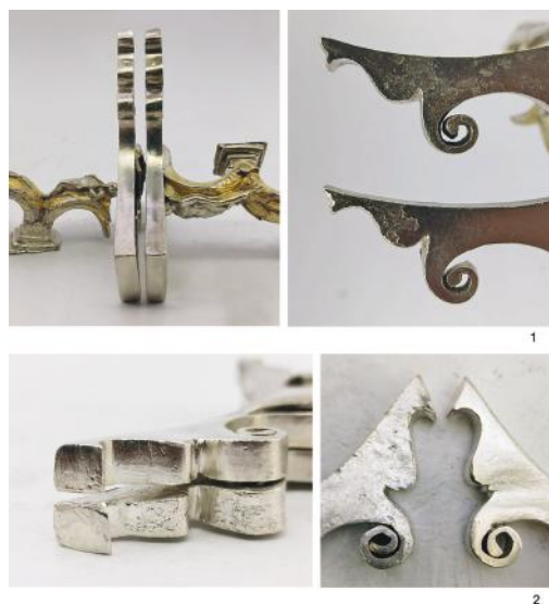
Рис. 26. Верхние пластины ручек, размеченные по трафарету. 1 – скифос Эпикрата; 2 – скифос Сфера Fig. 26. Upper plates of the handles, marked with a stencil. 1 – Epicrates' skyphos; 2 – Sfairos' skyphos
