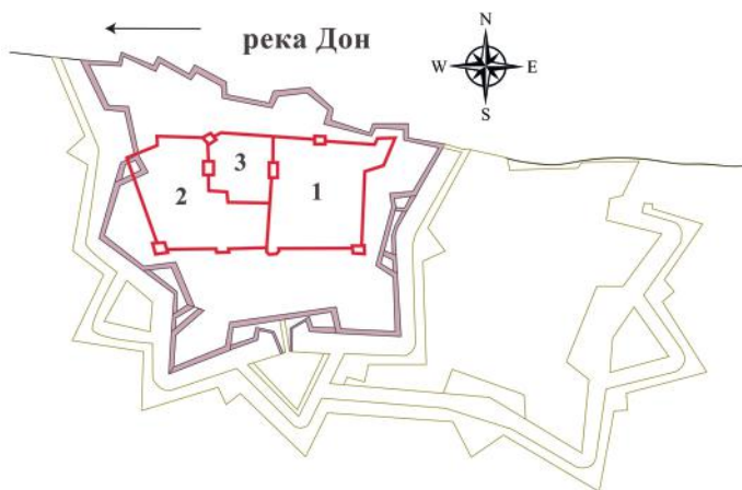
Рис. 2. План каменных укреплений Азова в 1642–1696 гг. (реконструкция) 2 . 1 – Таш-кале; 2 – Топрак-кале; 3 – Орта-кале. Красным цветом показаны стены османской постройки, сиреневым – российская земляная ограда 1696 г., зеленым – проект наружных укреплений 1697 г.
