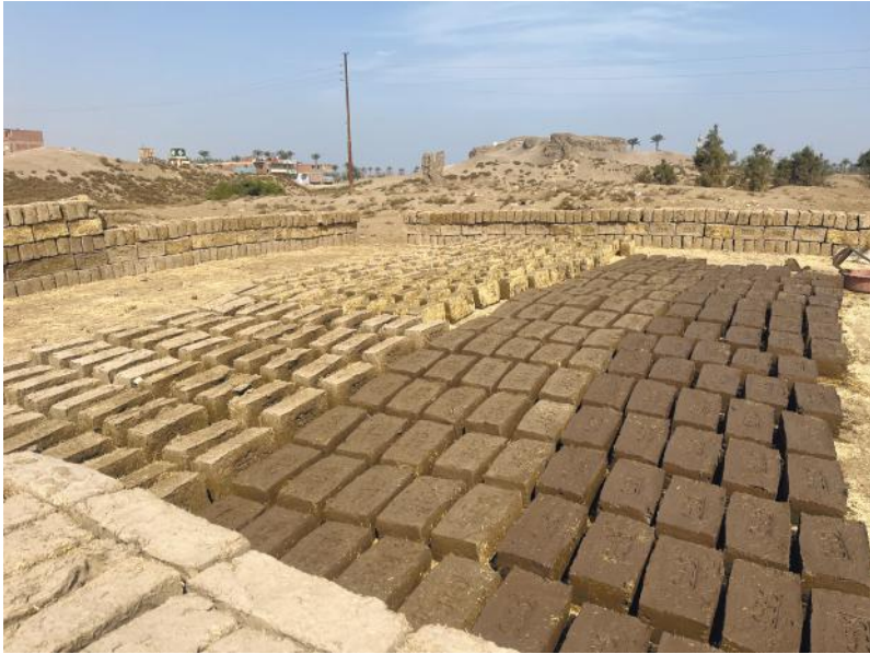
Рис. 4. Процесс сушки сырцового кирпича на Ком Тумане (фото В.И. Ярмолович) Fig. 4. Process of drying of mud-bricks at Kom Tuman (photo by V.I. Yarmolovich)
